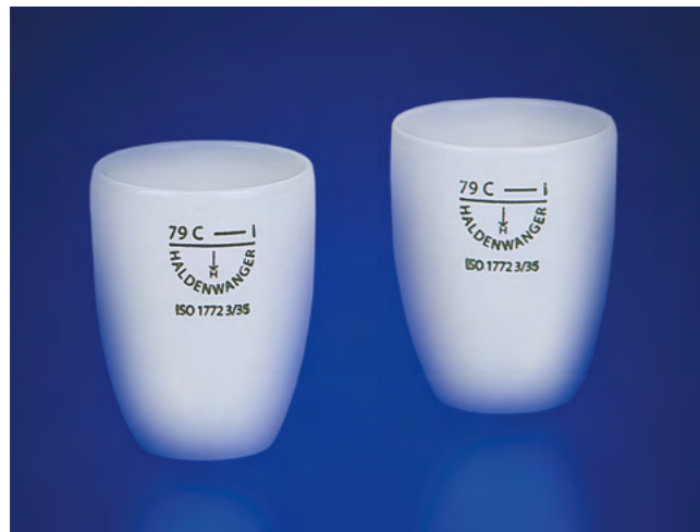
Haldenwanger-Tiegel vor (links) und nach (rechts) der thermischen Behandlung. Der Test belegt die thermische Stabilität der Glasur, auch nach mehrmaligen Anwendungen.
